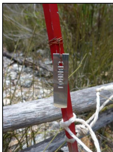
▲ Borne (piquet aluminium à tête peinte en rouge muni d'une étiquette métallique indiquant le numéro de la PP) [© J. HIVERT - CBNM]
