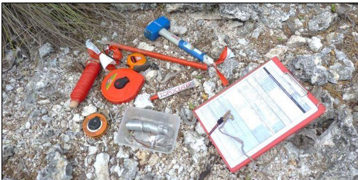
▲ Diamètre mètre, bagues métalliques numérotées, sous-main et bordereaux de terrain, fil métallique rouge, décamètre, mètre ruban, stylo tube, burin et massette [© J. HIVERT - CBNM]
