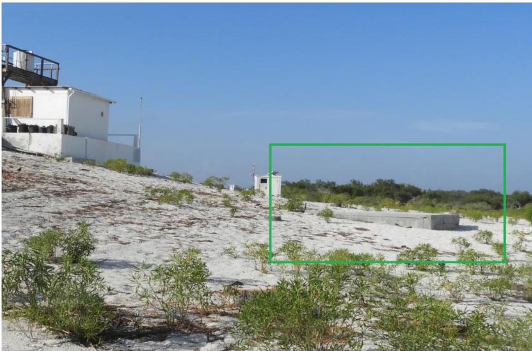
*Figure 1.19 : Dalle de béton qui va accueillir la cuve souple de récupération d'eau de pluie. Celle-ci se trouvera à 1 mètre de hauteur, en surplomb des modules de production ce qui devrait permettre d'avoir une pression suffisante pour l'arrosage.*
